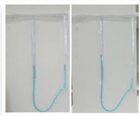
Εικόνα 14. Βεντουρίμετρο μέτρησης ταχύτητας ροής αέρα.
