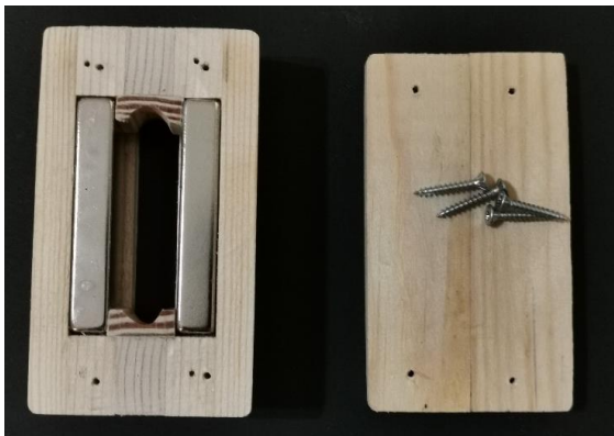
Εικόνα 1 : Η διάταξη παραγωγής “ομογενούς” μαγνητικού πεδίου (κάτω όψη). Φαίνονται τα δύο «τούβλα» νεοδυμίου που διατηρούνται παράλληλα σε μικρή απόσταση μεταξύ τους.
